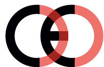
Marcatura CE contraffatta (troppo vicino)
